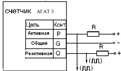
Рис. 4.5 Схема подключения импульсных выходов
