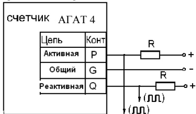
Рис. 4.5 Схема подключения импульсных выходов
